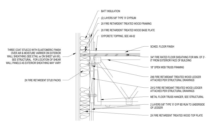
TYPE 3A CONST - EXTERIOR BEARING WALL
