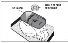
3. Voltee la taza hacia abajo y colóquela sobre el cartón extendido de la caja de empaque, para evitar daños.
